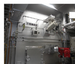
⑦焼却炉 内部はストーカという階段状の床になっており、ごみは、この床が前後に動くことにより、効率よく燃やされ、850℃以上の高温で完全燃焼します。
