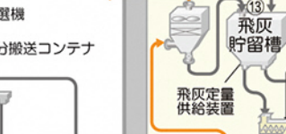
⑮飛灰貯留槽 飛灰貯留槽に貯留された飛灰は、薬剤と混練機で混ぜ合わされ、安定化されます。
